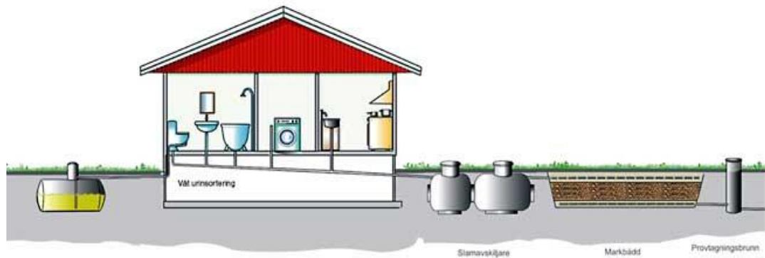
Figur 10. Exempel på hur en urinsorterande markbäddsanordning kan se ut. Källa Avloppsguiden
